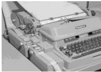
Şekil 2.4 Delikli kağıt şerit (punched tape) hazırlığında kullanılan bir makine: Flexowriter
