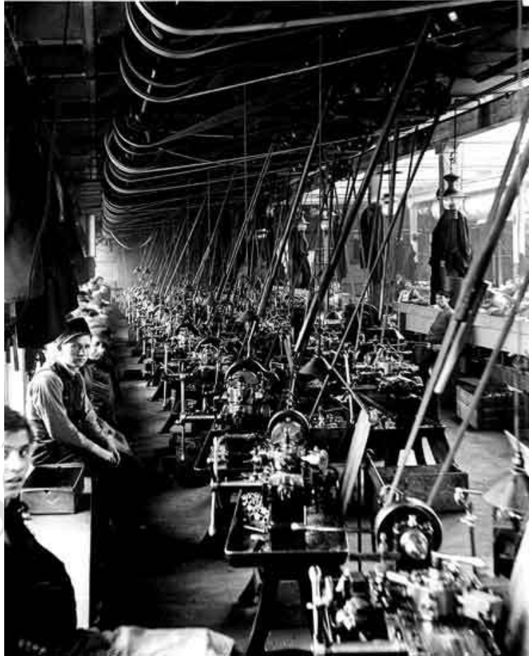
Şekil 1.9 Merkezi olarak üretilen momentin tezgahlara iletilmesi için kullanılan kayış-kasnak sistemleri
