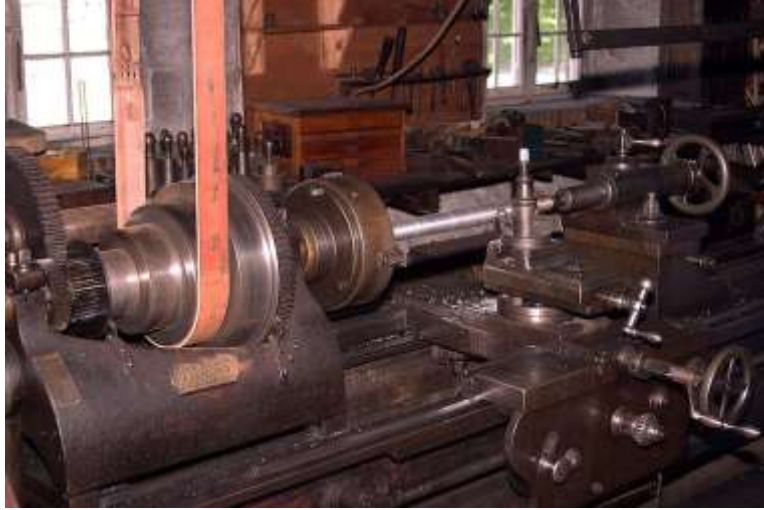
Şekil 1.10 Torna tezgahına momentin iletimi için kullanılan kayış-kasnak sistemi
