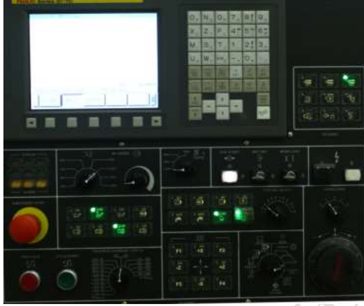
Şekil 2. 10 FANUC denetim birimine sahip CNC Tezgah panosu
