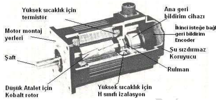
Şekil 2.20 Servo motor kesiti
