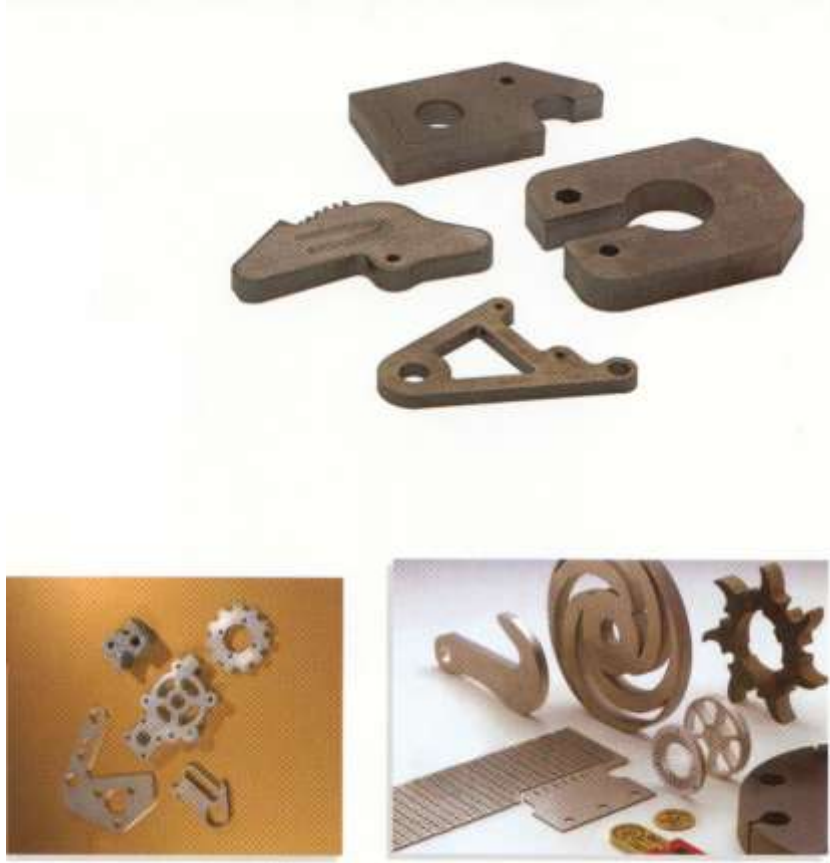
Şekil 3.12 Su jeti ve lazer ile kesme sonucu üretilen iş parçaları
