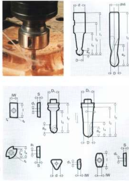
Şekil 4.45 Küresel uçlu parmak frezelerde ana boyutlar
