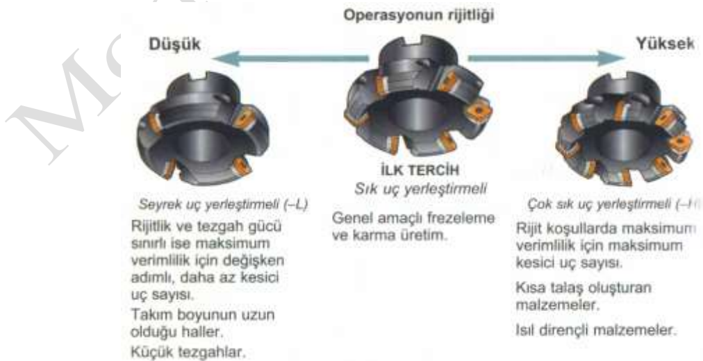
Şekil 4.39 Yüzey frezeleme için kullanılacak kesici takım kombinasyonları
