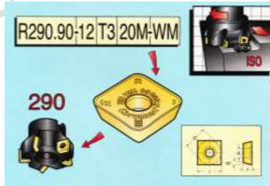
Şekil 4.58 R290.90-12 T3 20M-WM sipariş kodlu kesicinin açıklanışı
