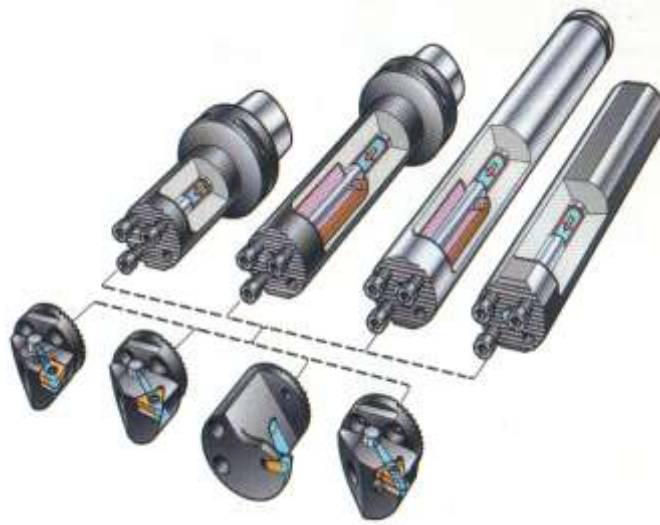
Şekil 4.35 Uzun deliklerin işlenmesi için kullanılabilecek titreşimsiz delik kateri
