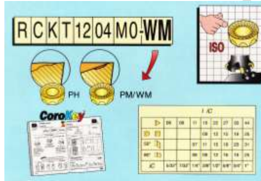
Şekil 4.57 RCKT 12 04 M0-WM kesici ucun açıklanışı
